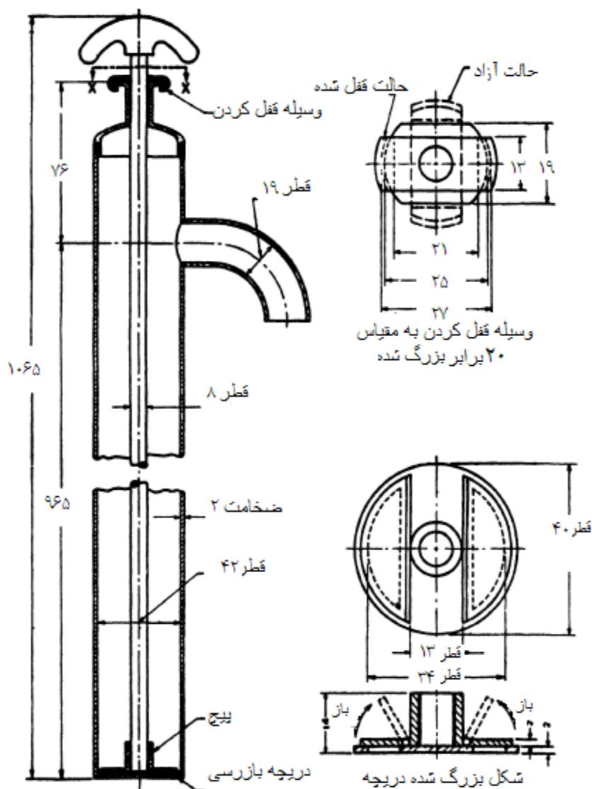
شکل ۱ - شمایی از تلمبه مخصوص نمونه برداری
